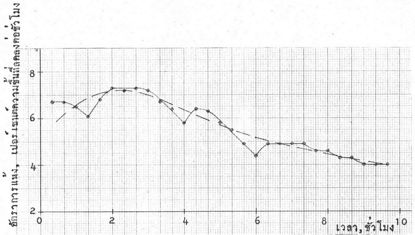
รูปที่ 6.9 กราฟแสดงอัตราการแห้งของกล้วยที่อุณหภูมิ 36 \pm 2 องศาเซลเซียส โดยใช้เครื่องมือแบบที่ 3 ( กังรูปที่ 6.9 )
