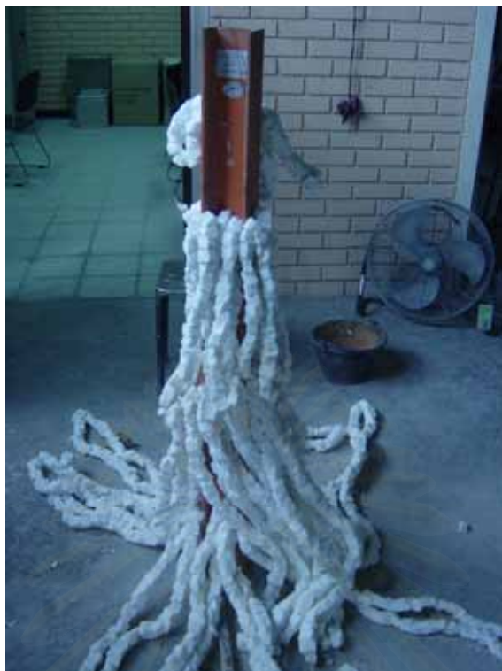
รูปที่ 3.9 สายอุปกรณ์วัดค่าอุณหภูมิที่ร้อยด้วยแผ่นเส้นใยเซรามิก
