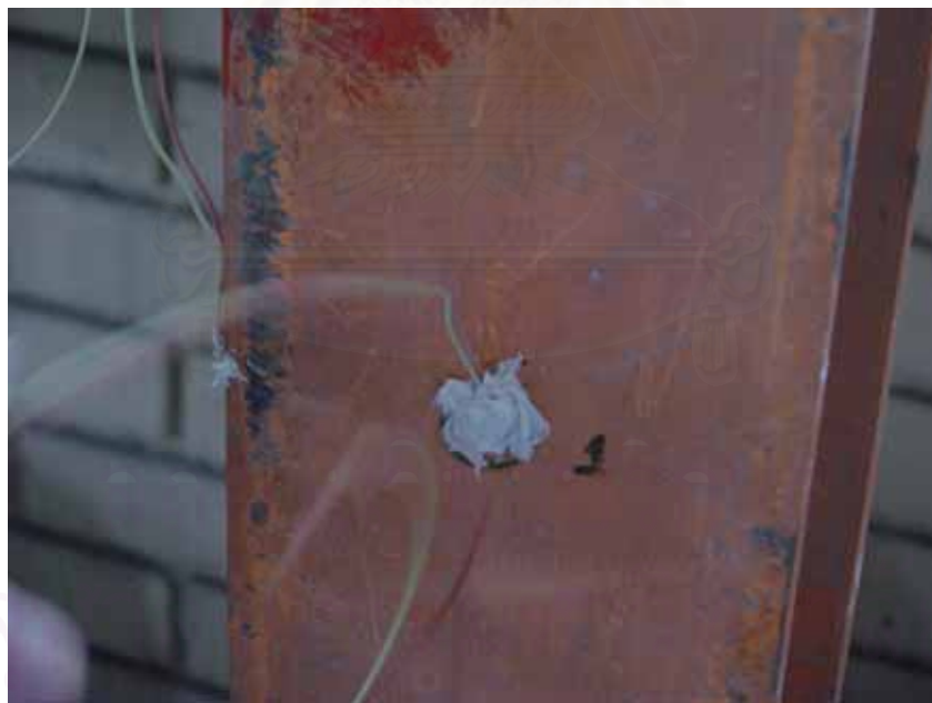
รูปที่ 3.8 ลักษณะการติดตั้งอุปกรณ์วัดค่าอุณหภูมิมบนพื้นผิวของชิ้นตัวอย่าง
