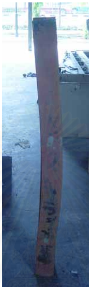
รูปที่ 6.4 ลักษณะการโก่งตัวของชิ้นตัวอย่างที่ออกแบบตามข้อแนะนำ
