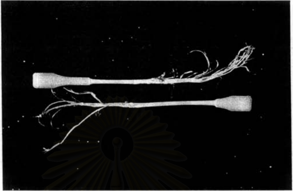
รูปที่ 4.23 ลักษณะของจีนทศอบเมื่อขาดหลังจากการทดสอบคุณสมบัติทางแรงดึง
