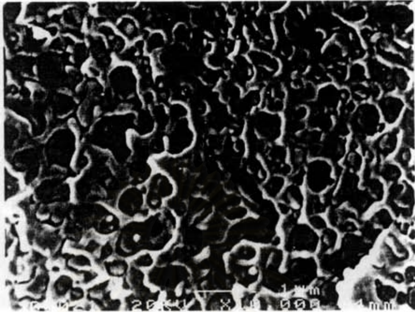
รูปที่ 4.10 ภาพถ่ายโครงสร้างจุลภาคบริเวณผิวหน้ารอยหักของโพลีเมอร์ผสม HDPE/PP (75/25) ไม่มี EPDM ฉีดขึ้นรูปที่อุณหภูมิ 210°C และมีกำลังขยาย 10,000 เท่า
