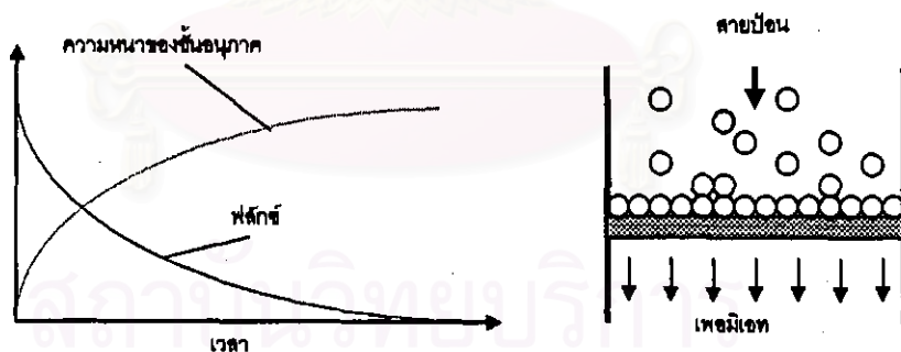
รูปที่ 3.3 กระบวนการกรองแบบไหลผ่าน
