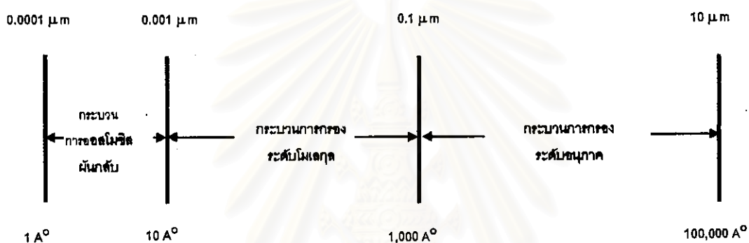
รูปที่ 3.1 ขนาดรูพรุนของเยื่อแผ่นที่ใช้ในกระบวนการกรอง
