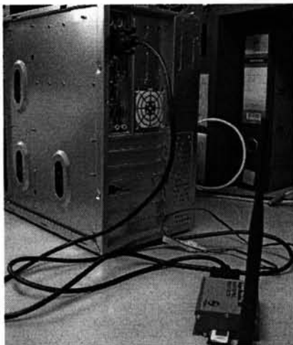
รูปที่ 7.3 การต่อร่วม GSM MODULE กับเครื่องบริการคอมพิวเตอร์
