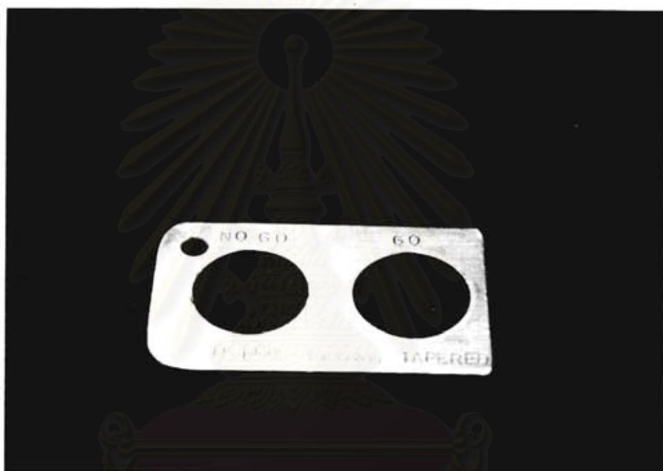
รูปที่ 13 เครื่องมือตรวจสอบมาตรฐานการปิดฝาจีบ ( inter crown tapered)
