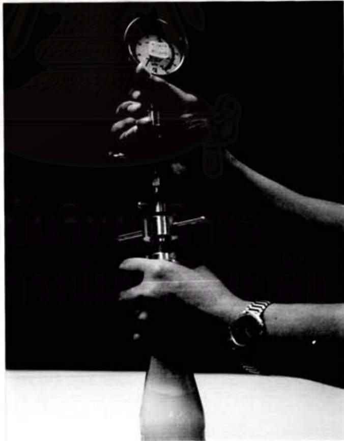
รูปที่ 12 ขั้นตอนการวัดปริมาตรก๊าซคาร์บอนไดออกไซด์ในขวด (Vol.CO 2 in bottle)
