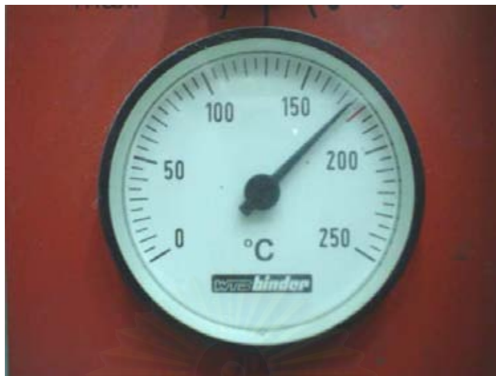
รูปที่ 6.3 หน้าปัดแสดงระดับอุณหภูมิของเตาอบอุณหภูมิ
