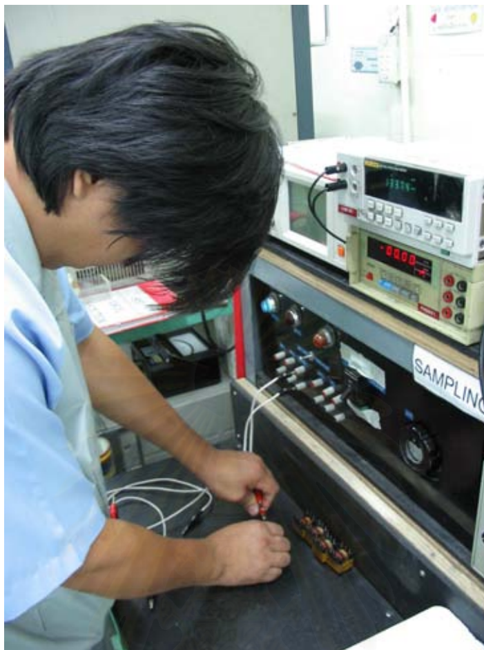
รูปที่ 7.11 การตรวจสอบคุณสมบัติแรงดันเหนี่ยวนำ
