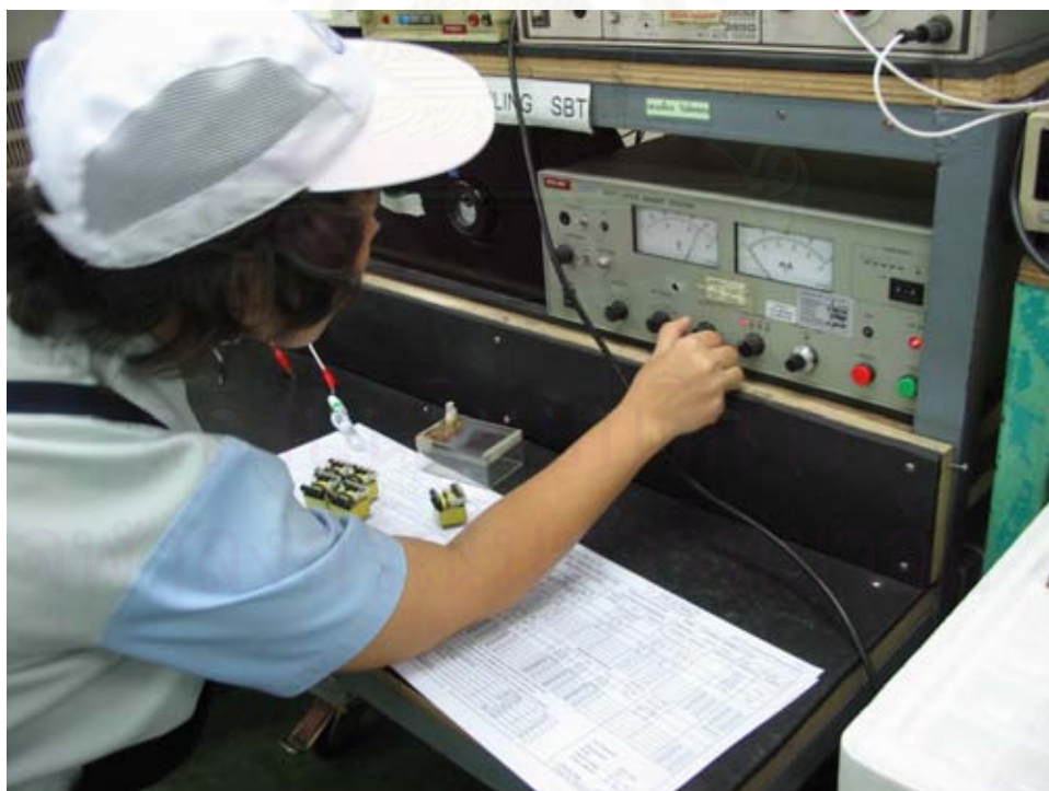
รูปที่ 7.10 การตรวจสอบคุณสมบัติความต้านทานฉนวน
