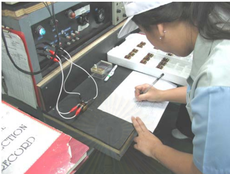
รูปที่ 7.9 การตรวจสอบคุณสมบัติไร้ภาระ (No Load Test)
