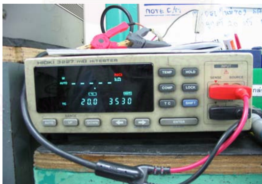
รูปที่ 7.12 อุปกรณ์วัดค่า DCR ซึ่งมีการชดเชยที่อุณหภูมิ 20 องศาเซลเซียส
