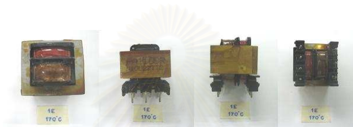
รูปที่ 7.1 หม้อแปลงทดสอบที่ถูกทดสอบด้วยอุณหภูมิ 170 องศาเซลเซียส
