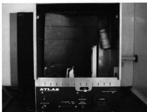
รูปที่ 3.3 เครื่องทดสอบ Atlas 45° automatic flammability tester
