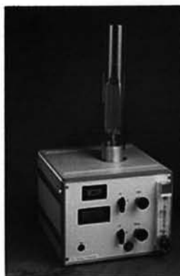
รูปที่ 3.4 เครื่องทดสอบหาค่า Limiting Oxygen Index
