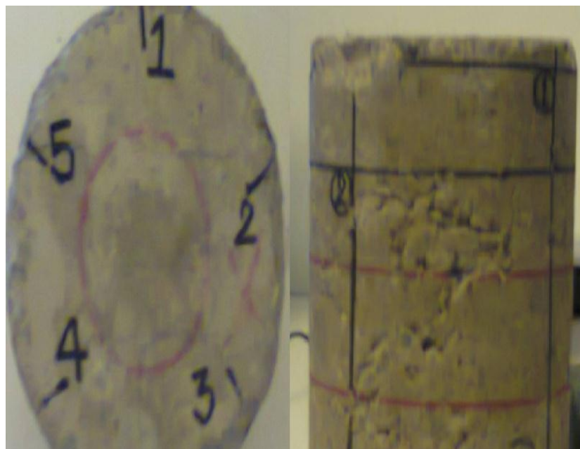
รูปที่ 3.5 ตำแหน่งที่ทำการวัดการเปลี่ยนแปลงปริมาตรของก้อนตัวอย่าง
