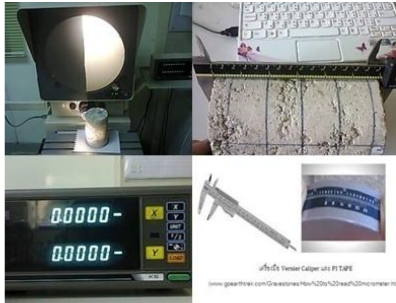
รูปที่ 3.4 เครื่องมือการวัดปริมาตรของก้อนตัวอย่าง
