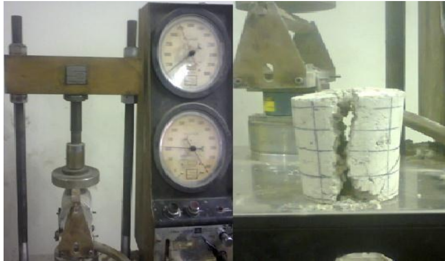
รูปที่ 3.8 การจัดวางก้อนตัวอย่างสำหรับการทดสอบกำลังรับแรงดึงทางอ้อม
