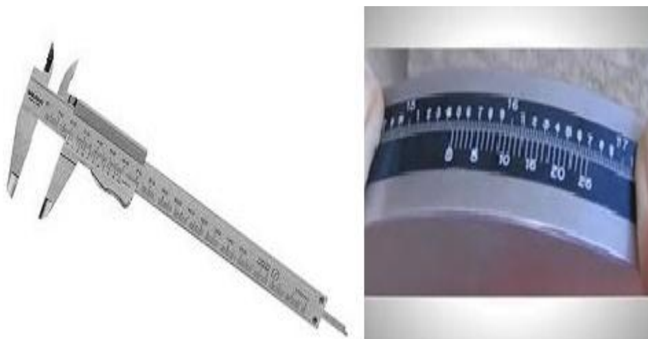
รูปที่ 2.27 เครื่องมือ Vernier Caliper และ PI TAPE
