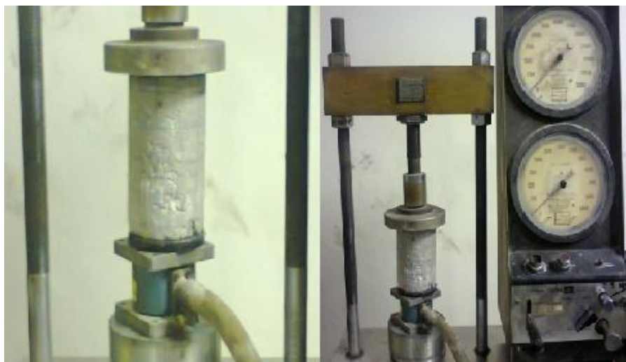
รูปที่ 3.6 การจัดวางก้อนตัวอย่างสำหรับการทดสอบค่ากำลังรับแรงอัดแกนเดียว
