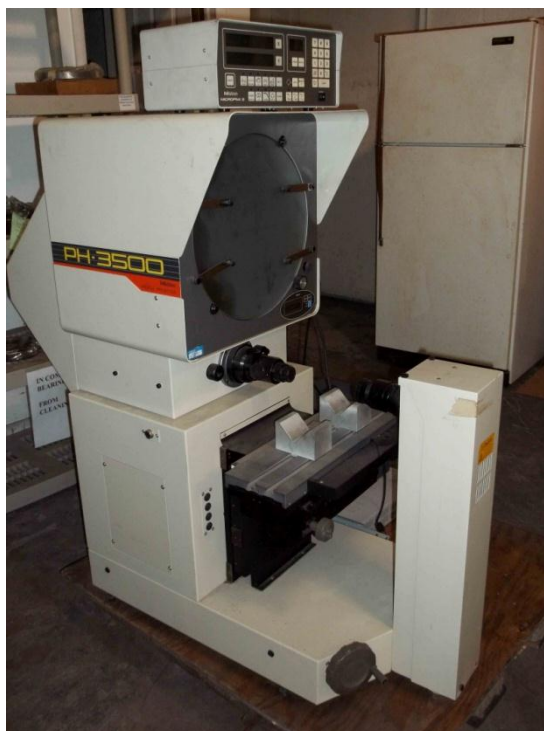
รูปที่ 2.28 การวัดการเปลี่ยนแปลงปริมาตรโดยการใช้ Profile Projector
