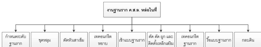
ภาพที่ 4.6 การแยกย่อยหน่วยงานภายในงานก่อสร้างฐานราก ค.ส.ล. หล่อในที่
