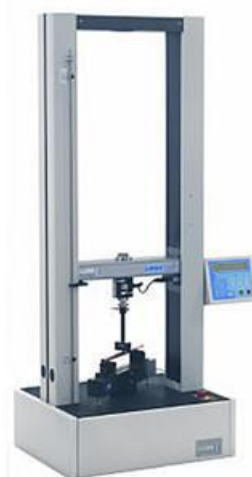
รูปที่ 2.9 เครื่องทดสอบความแข็งแรงของวัสดุ (Universal Testing Machine)
