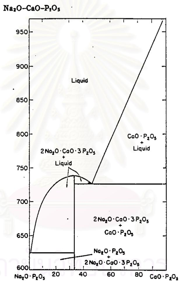
FIG. 486.—System  $\text{Na}_2\text{O}-\text{P}_2\text{O}_5-\text{CaO}-\text{P}_2\text{O}_5$ .
