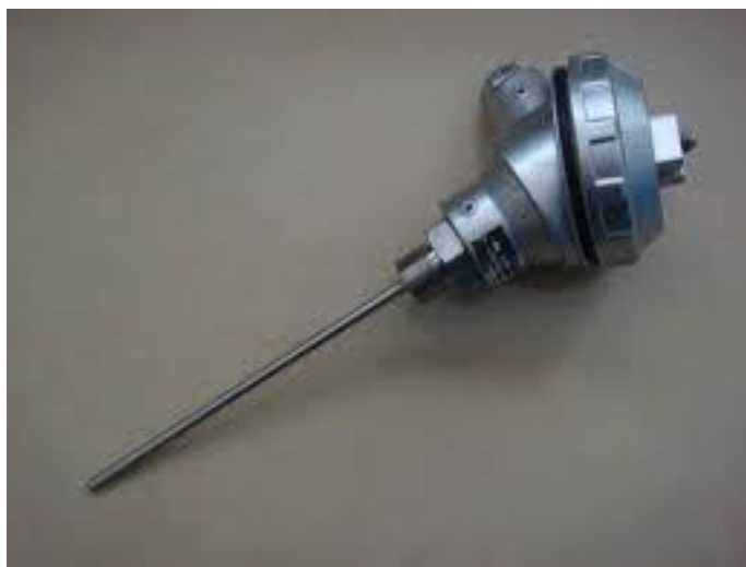
ภาพที่ 5.4 อุปกรณ์วัดอุณหภูมิน้ำและไอเสีย
