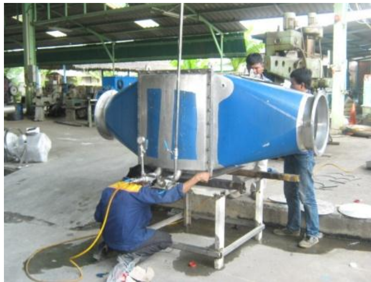
ภาพที่ 4.7 การทดสอบท่อด้วยวิธีความดันอุทกสถิต (Hydrostatic Test)
