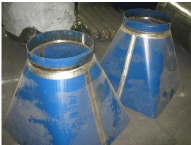
ภาพที่ 4.4 ท่อด้านเข้าและออกอีโคโนไมเซอร์ของก๊าซเสีย
