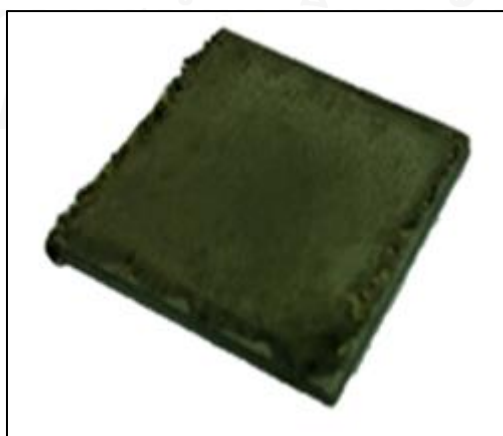
ภาพที่ 4. 1 ลักษณะพื้นผิวของชิ้นงานภายหลังการชุบเคลือบโลหะผสมนิกเกิลทั้งสแตนผลึกนาโนลงบนผิวชิ้นงานเหล็กกล้าไร้สนิม
