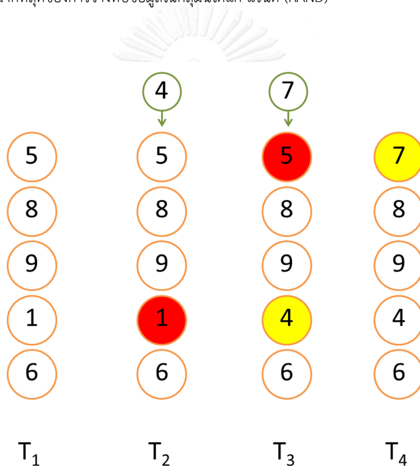
ภาพที่ 2-8 ตัวอย่างการทำงานของอัลกอริธึมการวางทับข้อมูลแรนด์
