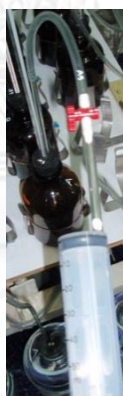
รูปที่ 3.13 แสดงการสูบอากาศออกจากขวดหมัก
