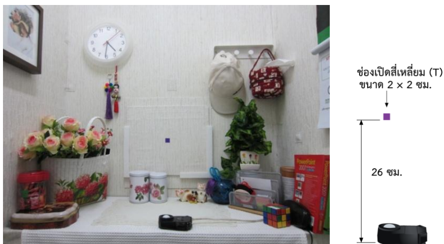
ภาพที่ 3.4 การจัดวางวัตถุเพื่อจำลองสภาวะห้องของผู้สังเกต
