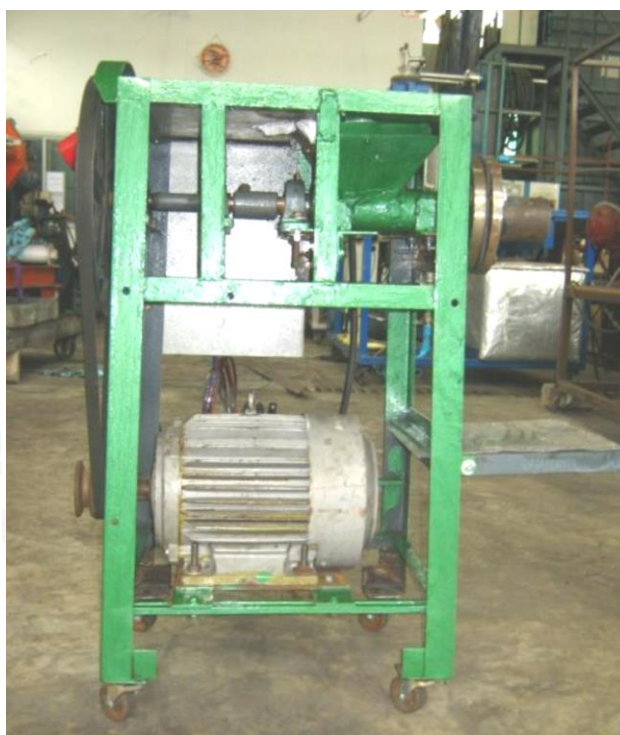
ภาพที่ ก.3 เครื่องอัดแท่งแบบเอ็กทรูชั่น (Extrusion)
