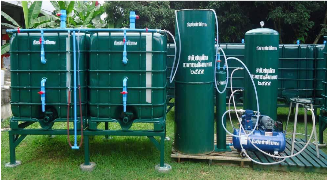
รูปที่ 7 ระบบผลิตก๊าซชีวภาพจากขยะอินทรีย์ ขนาด 2,000 ลิตร
