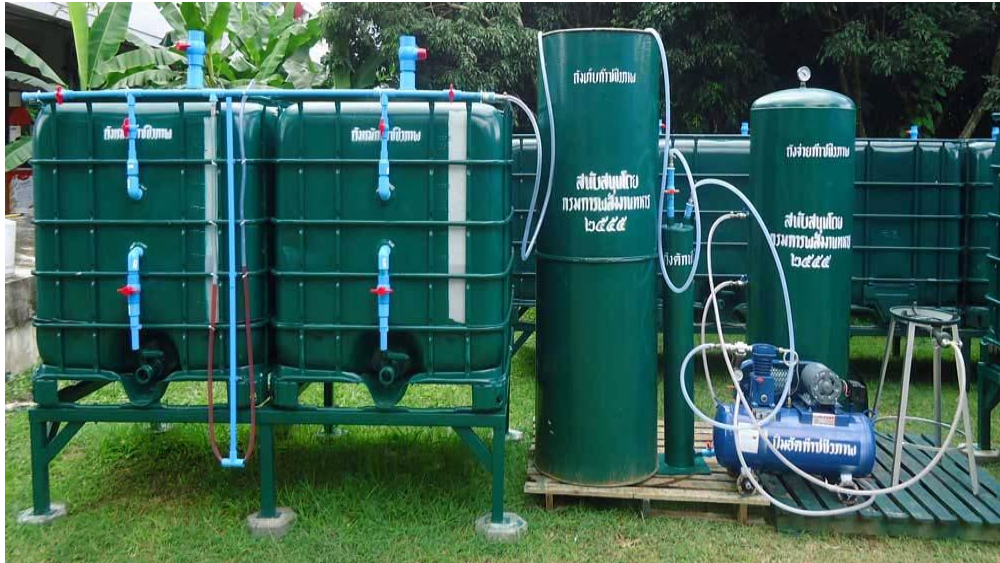
รูปที่ 3 ระบบผลิตก๊าซชีวภาพจากขยะอินทรีย์ ขนาด 2,000 ลิตร
