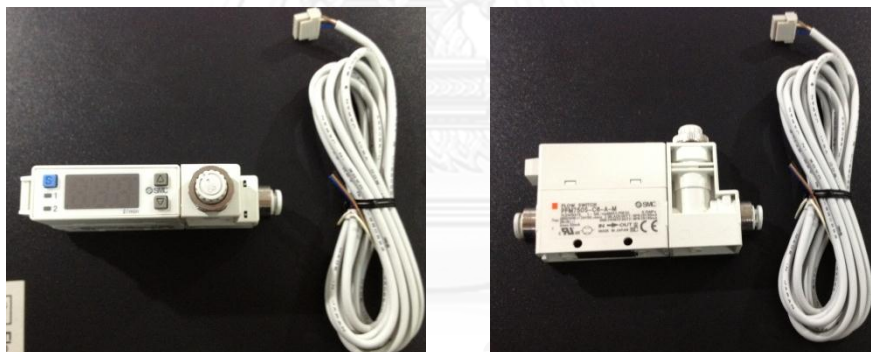
รูปที่ 8 เครื่องวัดก๊าซ (Digital Flow Switch รุ่น PFM750S-C6-A-M)
