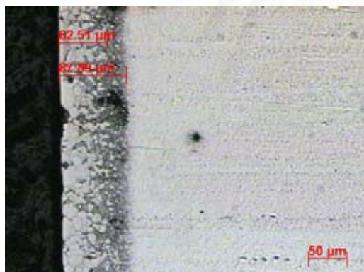
ก) ชิ้นงานที่มีการสูญเสียคาร์บอนที่ผิว และ ทำไนตรายด์แบบพลาสมาที่อุณหภูมิ 773K เป็นเวลา 36 ks
