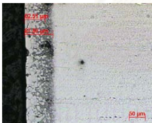
ก) ชิ้นงานที่มีการสูญเสียคาร์บอนที่ผิว และทำในตรายคิงแบบพลาสมาที่ อุณหภูมิ 773K เป็นเวลา 10 ชั่วโมง
