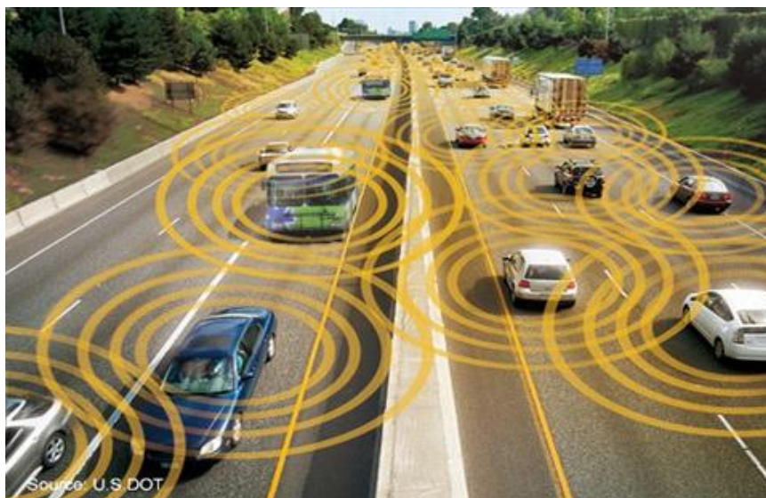
ภาพที่ 2.1 แสดงลักษณะของการสื่อสารที่เกิดขึ้นระหว่างยานพาหนะ [13]
