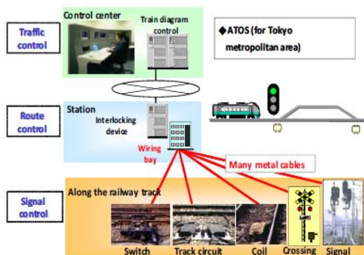
รูปที่ 2. 4 รูปแบบระบบควบคุมของรถไฟ
