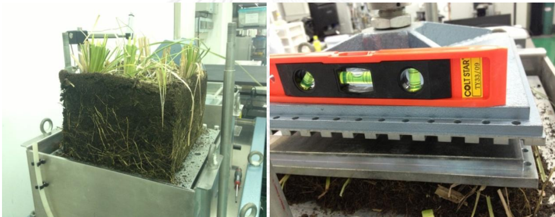
รูปที่ 3.13 ชุดเครื่องมือทดสอบ large direct shear และ การแสดงกล่องตัวอย่างทดสอบถ่ายรูปเพื่อเก็บไปเตรียมทำการวิเคราะห์รูป(image processing)
