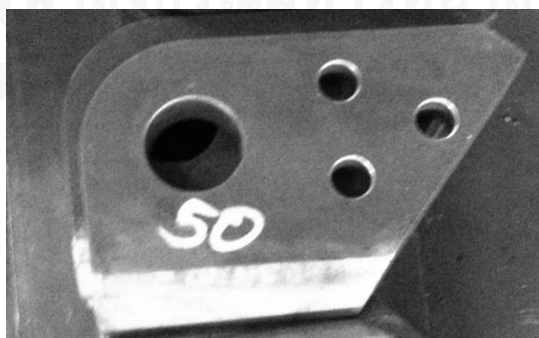
รูปที่ 3-12 ถึงชิ้นงานที่ผ่านการลบคมชิ้นงาน
