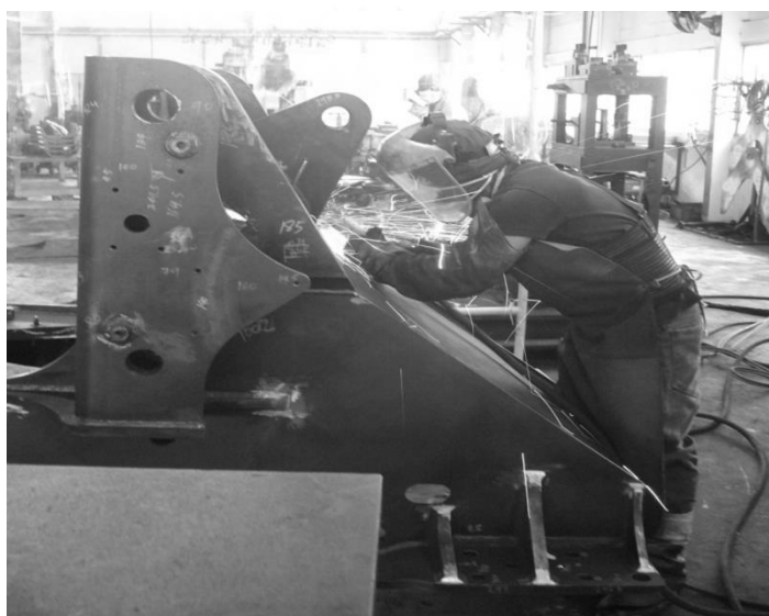
รูปที่ 3-20 ขั้นตอนการเชื่อมประกอบแอสซีส่วนหน้า
