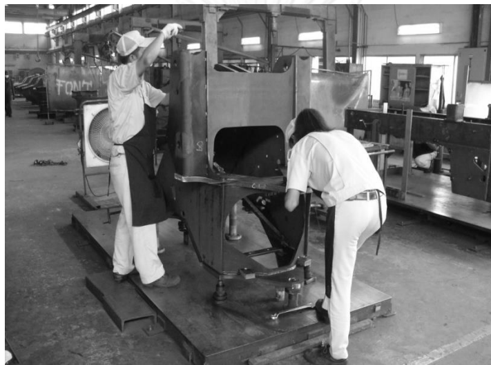
รูปที่ 3-22 ขั้นตอนการตรวจสอบคุณภาพครั้งที่ 2 แซสซีส่วนหน้า
