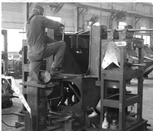
รูปที่ 3-16 ขั้นตอนการทำงานการเชื่อมประกอบชิ้นส่วนขั้นต้นส่วนหน้า
