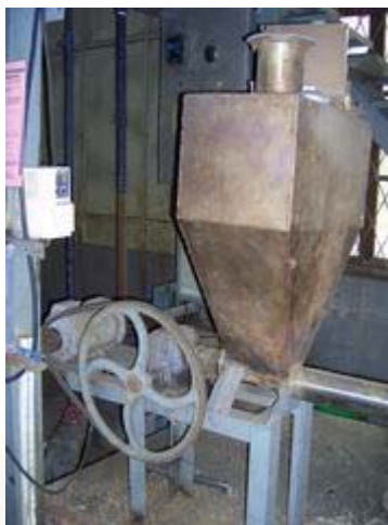
รูปที่ 3.12 ระบบป้อนเชื้อเพลิงเข้าสู่เตาเผา (fuel feeder)
