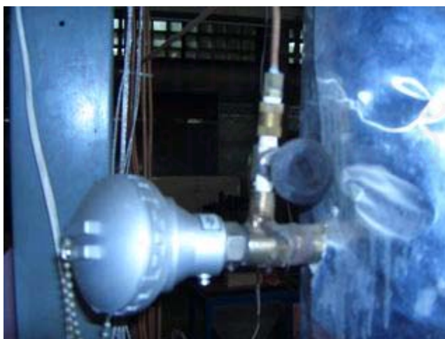
รูปที่ 3.15 Probe สำหรับวัดอุณหภูมิและวัดองค์ประกอบของแก๊ส
