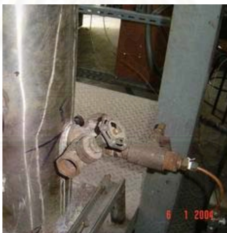
รูปที่ 3.13 หัวเผาแก๊สหุงต้ม (LPG burner)
