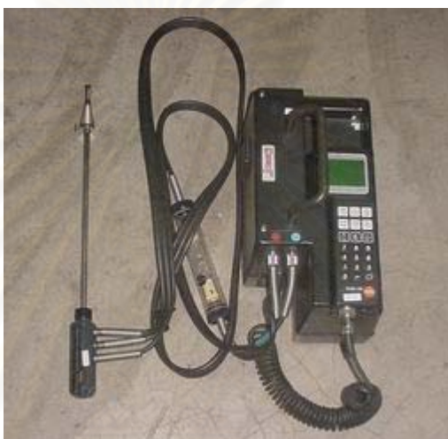
รูปที่ 3.18 เครื่องวัดฟลูแก๊ส (Flue gas Analyzer)
