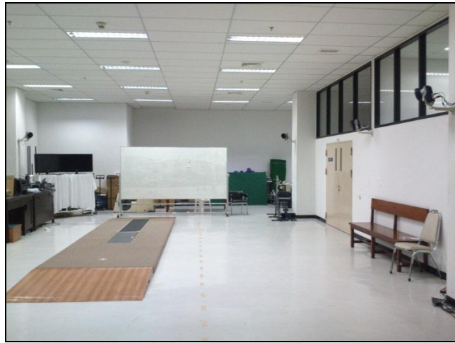
ภาพที่ 3.3 แสดงตำแหน่งชุดกล้องอินฟราเรดความเร็วสูง เครื่องวัดแรงกดบนฝ่าเท้า ในห้องปฏิบัติการสำหรับวิเคราะห์การเคลื่อนไหว
