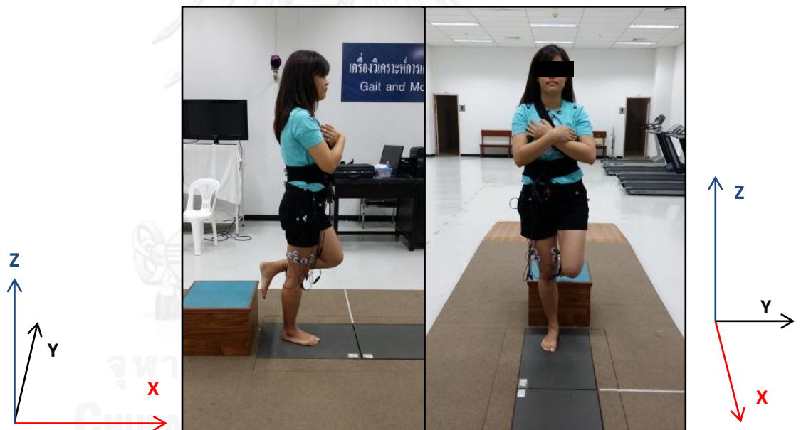
ภาพที่ 3.4 แสดงการทดสอบความมั่นคงของกระดูกสันหลัง และเชิงกราน และลักษณะของระนาบแสดงทิศทางกรวิเคราะห์การเคลื่อนไหว
