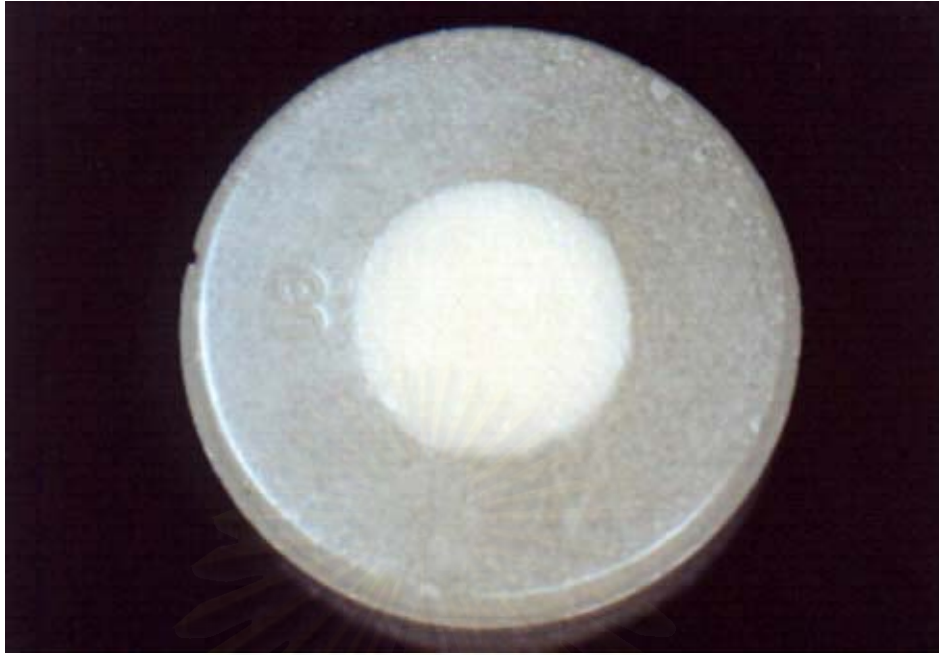
รูปที่ 25 ชิ้นงานหลังจากยึดด้วยอะคริลิกเรซินใส
