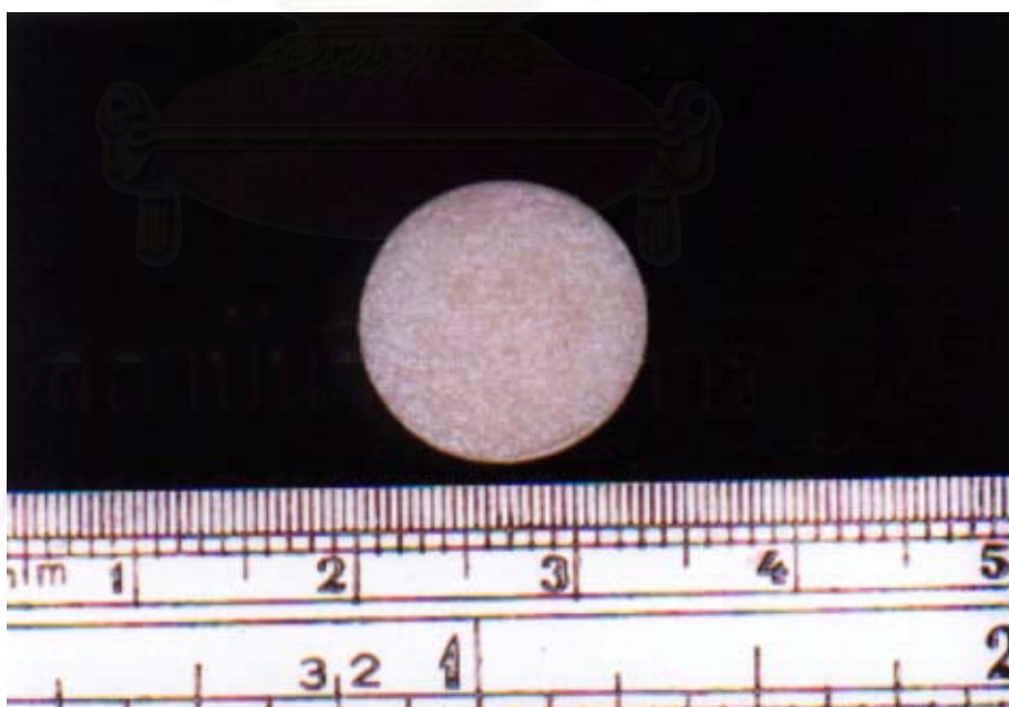
รูปที่ 10 แผ่นกลมอะลูมินัสพอร์ซเลนภายหลังการเผา
