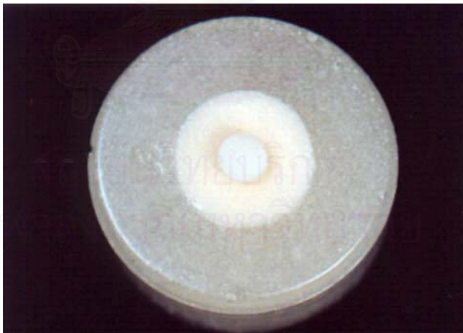
รูปที่ 32 ชิ้นงานหลังจากยึดพอร์ซเลนทั้งสองชนิด
