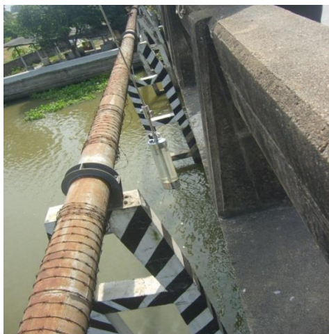
ภาพที่ 5.3 จุดเก็บตัวอย่างน้ำทิ้งจากแหล่งน้ำสาธารณะควบคุม
