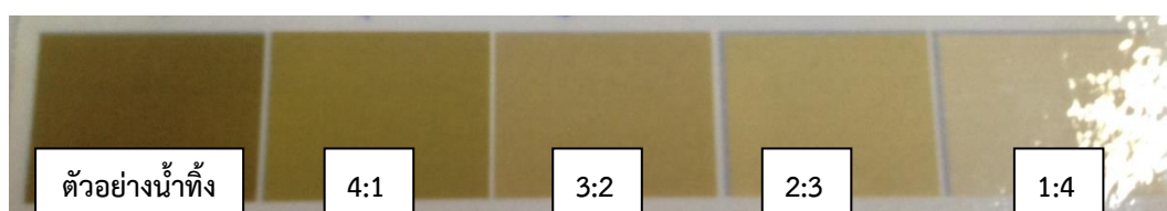
ภาพที่ 5.17 แถบสีน้ำทิ้งเจือจางจากโรงงานย้อมผ้าด้วยระบบค่าสีมันเซลล์ วันที่ 3
