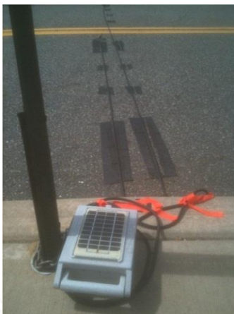
ภาพที่ 2.8 เครื่องนับแบบท่อความดัน (Pneumatic Road Tube)
