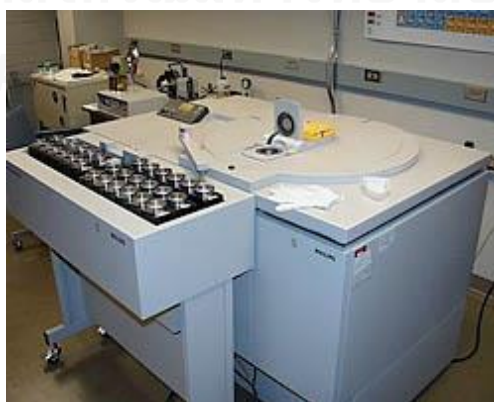
ภาพที่ 3.3 เครื่องวิเคราะห์หาปริมาณธาตุองค์ประกอบในสารตัวอย่าง โดยใช้การวัดปริมาณรังสีเอกซเรย์ฟลูออเรสเซนซ์ (X-ray Fluorescence)
