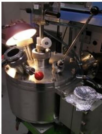
ภาพที่ 3.1 เต้าอาร์กสุญญากาศ (Arc Melting Furnace) และแม่พิมพ์ที่ใช้ในการหลอม [13]
