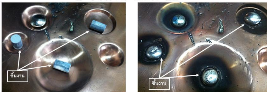
ภาพที่ 3.2 ชิ้นงานก่อนและหลังหล่อโดยเต้าอาร์กสุญญากาศ [14]
