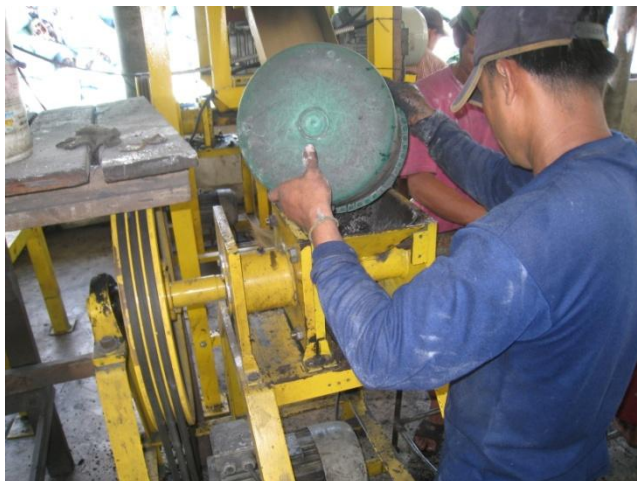
ภาพที่ 2.19 การทรงแวนผสมลงสู่เครื่องอัดไฮโดลิก
