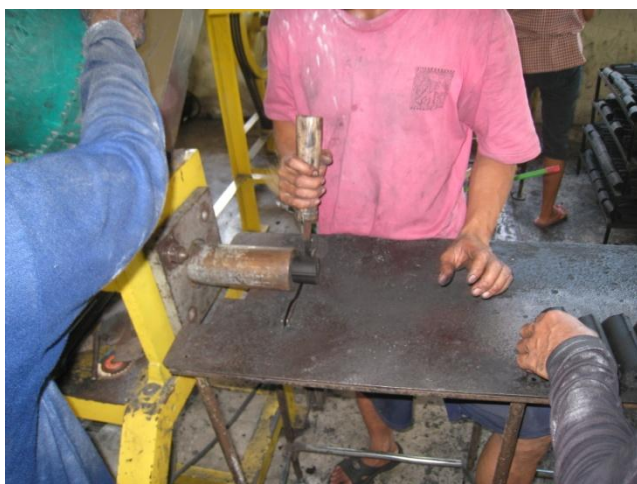
ภาพที่ 2.20 การตัดแต่งถ่านที่ถูกเครื่องอัดแต่งออกมา
