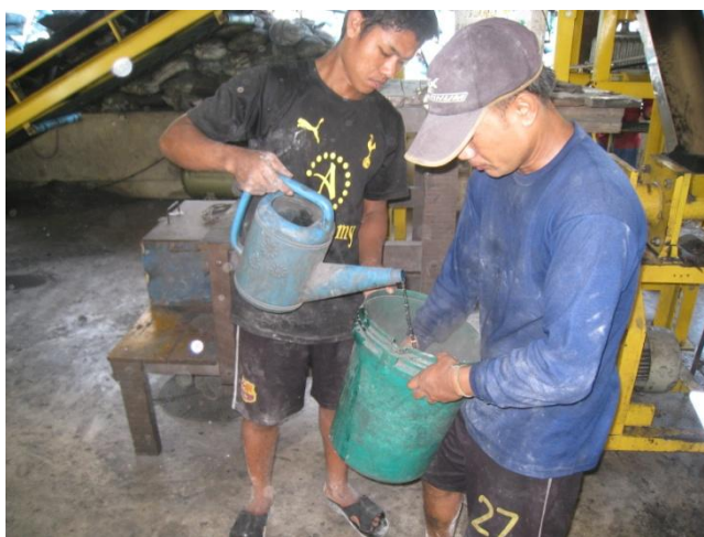
ภาพที่ 2.18 การผสมผงถ่านจากกากตะกอนและเปลือกผลไม้โดยมีแป้งมันสำปะหลังและน้ำเป็นตัวประสาน
