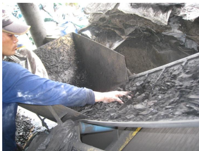
ภาพที่ 2.17 การนำเปลือกผลไม้ที่เผาเป็นถ่านคาร์บอนแล้วเข้าสู่เครื่องบด
