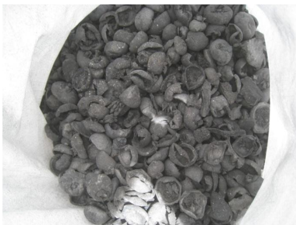
ภาพที่ 2.14 เปลือกมังคุดที่ถูกเผาเป็นคาร์บอน
