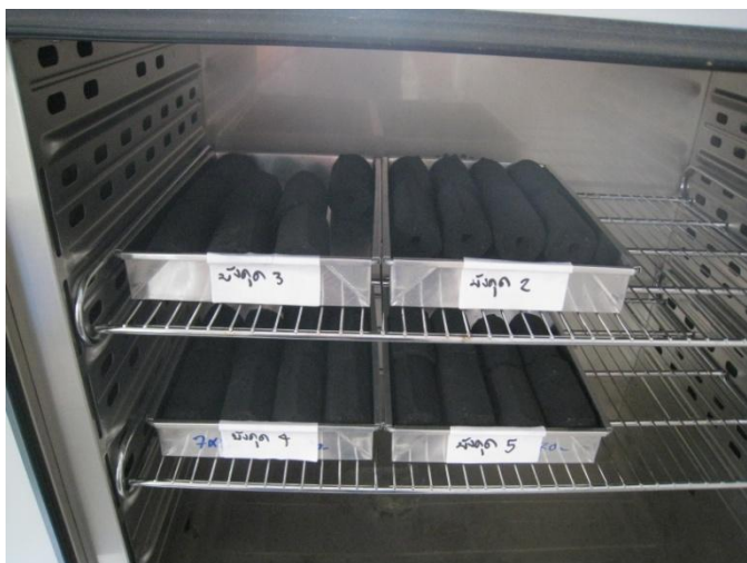
ภาพที่ 2.21 ทำการอบเชื้อเพลิงอัดแท่งในตู้อบเพื่อไล่ความชื้น
