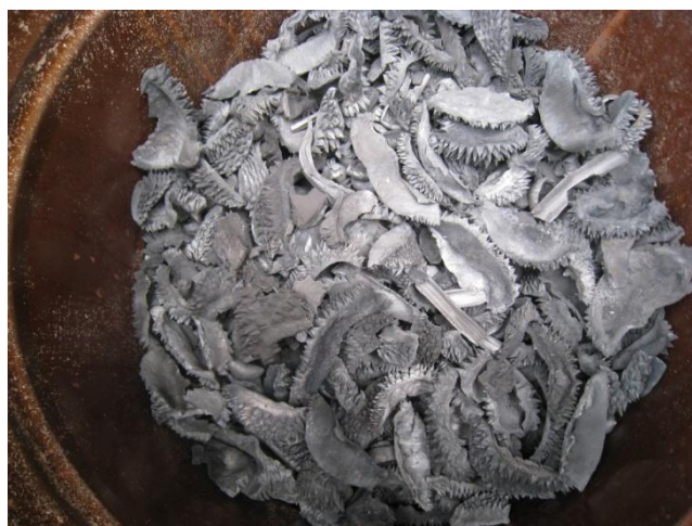
ภาพที่ 2.10 เปลือกทุเรียนหลังการเผาให้เป็นถ่านคาร์บอน
