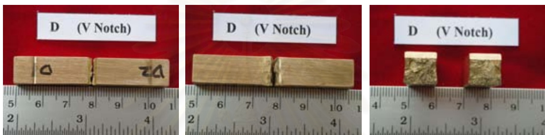
ภาพที่ 4.9 ลักษณะของชิ้นงานทดสอบชนิดมีรอยบากรูปตัววี หลังการทดสอบความต้านทานแรงกระแทกแล้ว
