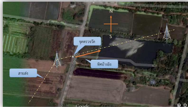
รูปที่ 5-4 แนวสายส่ง และทิวค้ำอิงที่ติดตั้งสำหรับการวัดทิศทางลม
