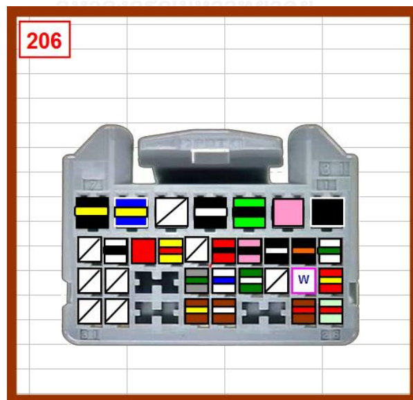
รูปที่ 3.6 ตัวอย่างแผนผังบอกตำแหน่งเสียบสายไฟของหัวเชื่อมสายไฟรุ่น 206
