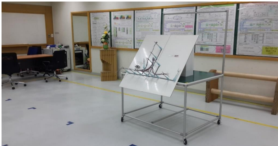
รูปที่ 3.1 ห้องทำการทดลองการเสียบสายไฟและโต๊ะจำลองสถานีนงานสูง 1 เมตร
