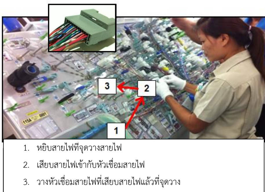
รูปที่ 1.4 ขั้นตอนการเสียบสายไฟเข้าหัวเชื่อมสายไฟ
