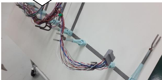
7 วางหัวเชื่อมสายไฟลงบนกระดานประกอบ หยุดบันทึกวิดีโอ
