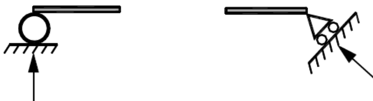
ภาพที่ 2.4 แสดงสัญลักษณ์ของฐานรองรับแบบยึดหมุนเคลื่อนที่ได้ (Roller Supports) [3]
