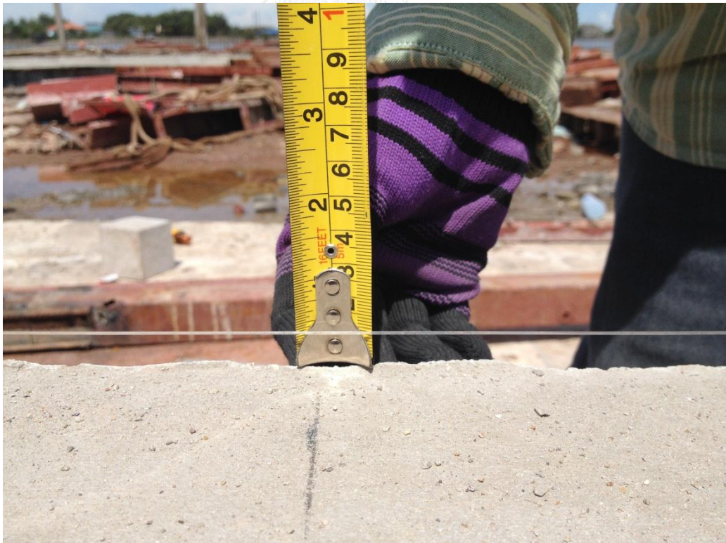
ภาพที่ 4.40 ตรวจสอบการแอ่นตัวของแผ่นพื้น ที่ระยะ 4.00 ม. เท่ากับ 15.0 มม.
