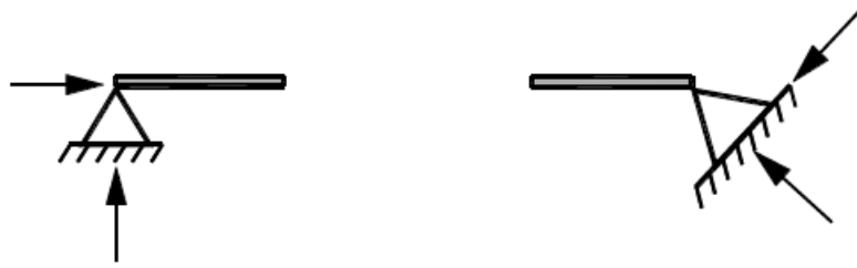
ภาพที่ 2.6 แสดงสัญลักษณ์ของฐานรองรับแบบยึดหมุนเคลื่อนที่ไม่ได้ (Hinge Supports) [3]
