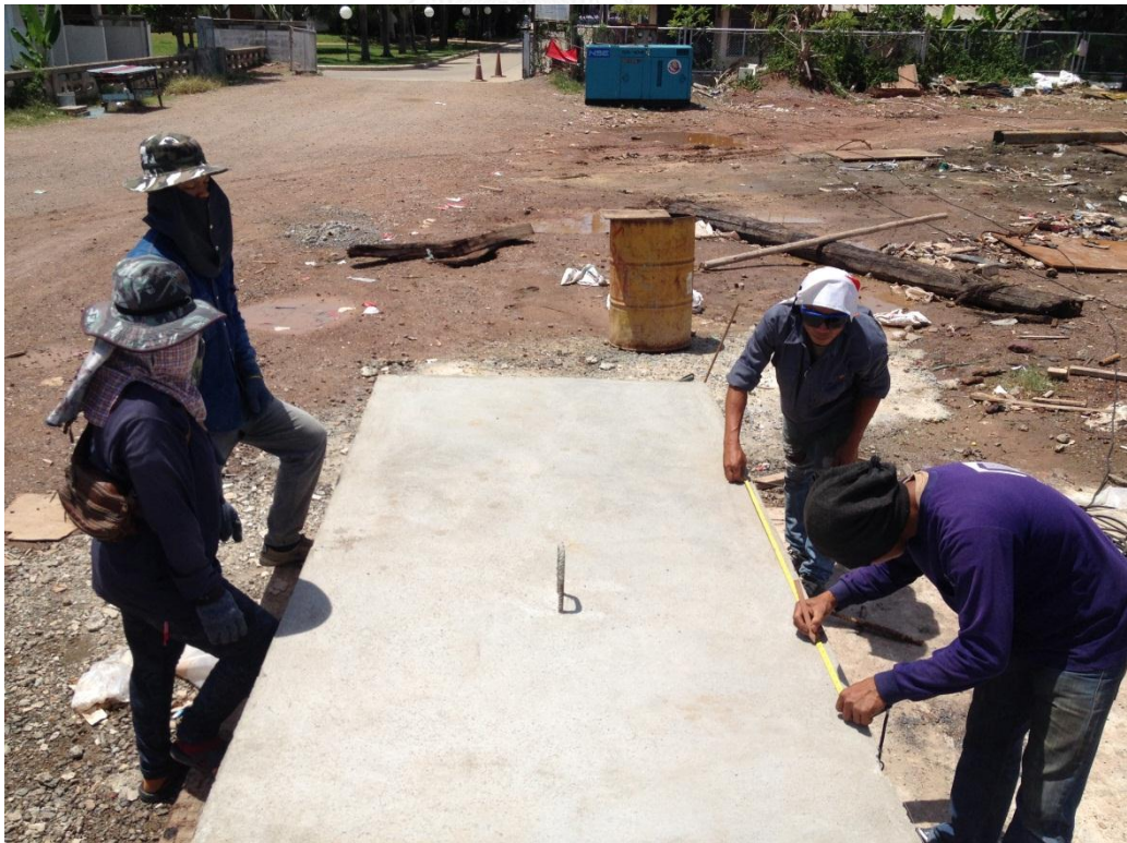
ภาพที่ 4.34 วัดระยะทุกๆ 1.00 ม. เพื่อวางก้อนทดสอบ
