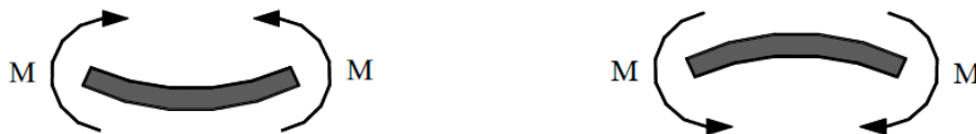
ภาพที่ 2.25 แสดงเครื่องหมายและสัญลักษณ์แทนโมเมนต์ดัด [3]
