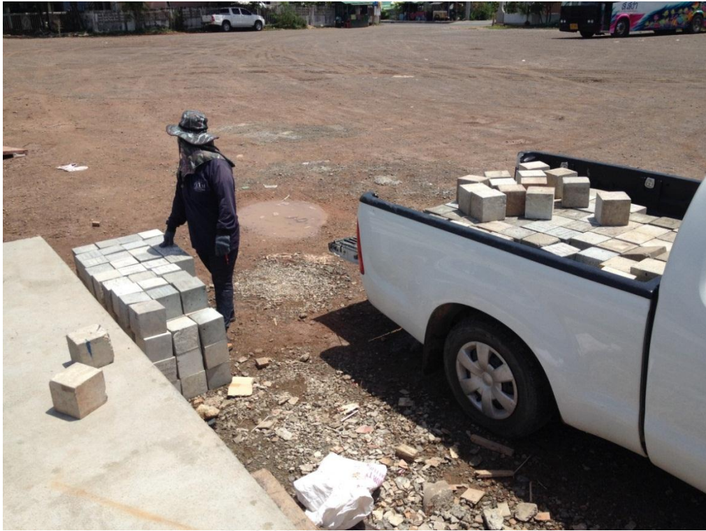
ภาพที่ 4.31 ตัวอย่างการวางคอนกรีตทรงลูกบาศก์ ขนาด 0.15 \times 0.15 \times 0.15 ม. น้ำหนักเฉลี่ย 8.00 กิโลกรัม ต่อ 1 ก้อน ซึ่งจะนำมาทดสอบ โดยการแทนน้ำหนัก Live Load = 200 กก./ตร.ม.
