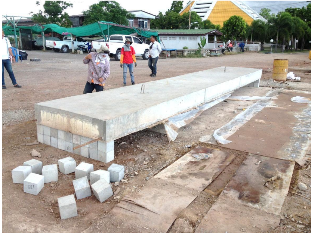
ภาพที่ 4.28 แผ่นพื้นถูกวางไว้บน Support เรียบร้อย
