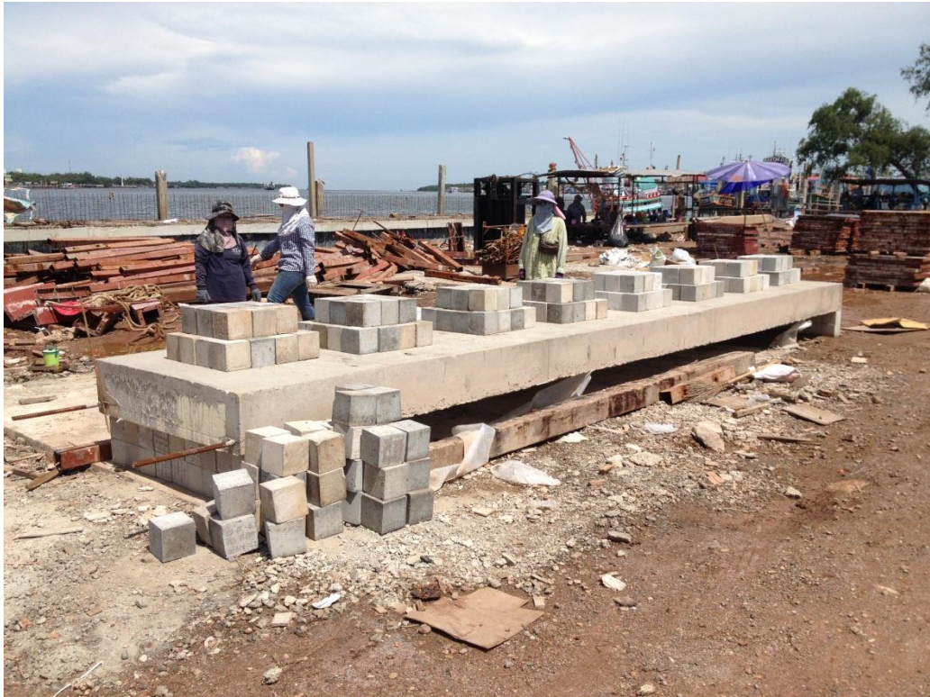
ภาพที่ 4.39 วางแท่งคอนกรีต โดยแต่ละส่วนรับน้ำหนัก LL=200 \text{ Kg./m}^2
