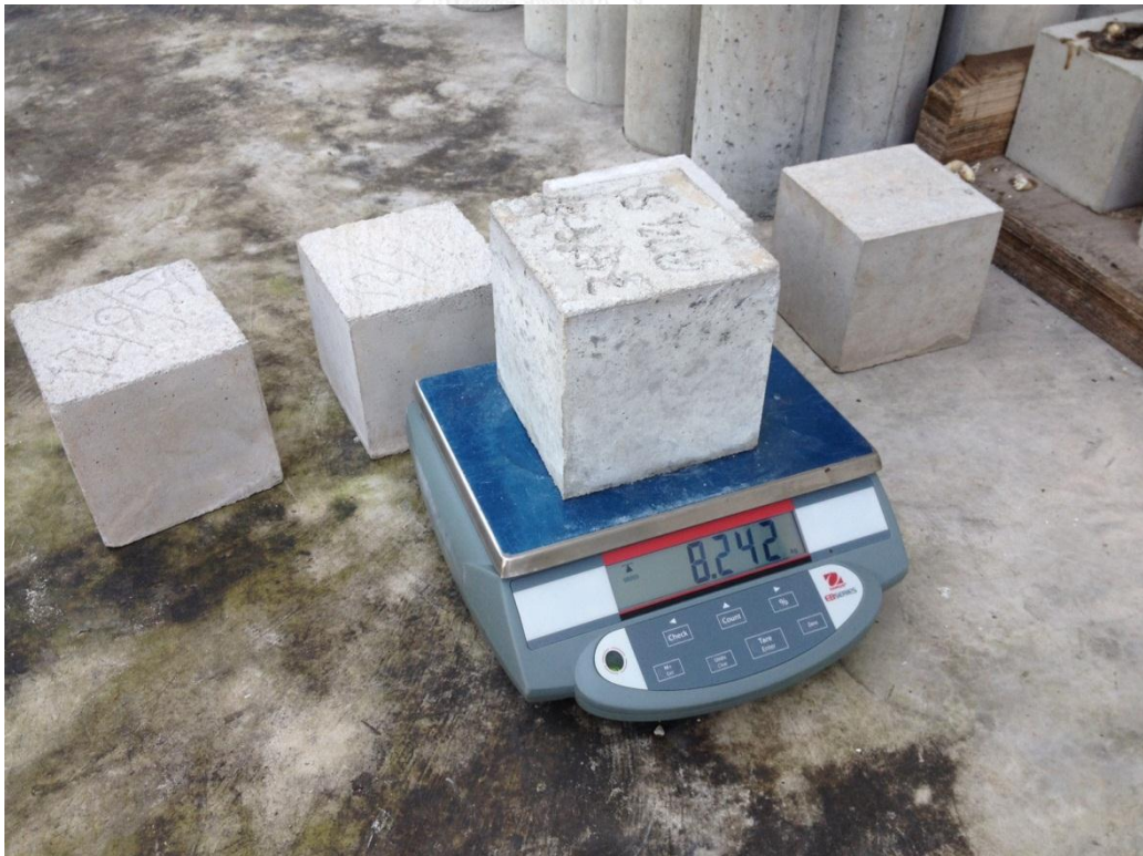
ภาพที่ 4.38 ชั่งน้ำหนักก้อนตัวอย่างคอนกรีต
