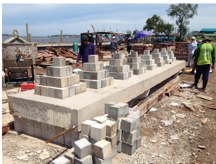
ภาพที่ 4.41 วางแท่งคอนกรีต โดยแต่ละส่วนรับน้ำหนัก LL=248 Kg/ m^2
