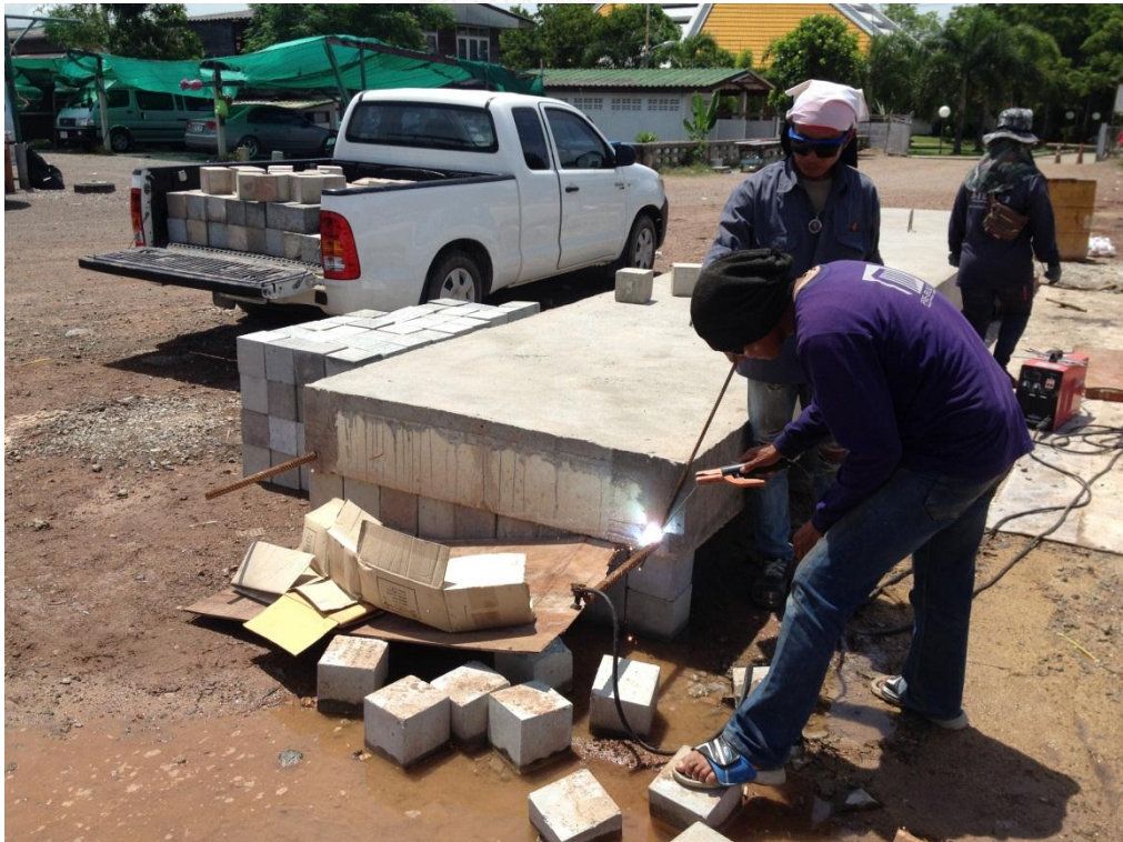
ภาพที่ 4.32 ทำการเชื่อมอุปกรณ์ตรวจสอบการแอ่นตัวของแผ่นพื้น
