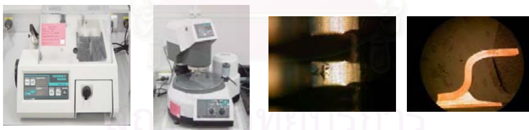
รูปที่ 4.11 เครื่องตัด เครื่องขัดและรูปแสดงผลที่ได้จากการตัดและขัดชิ้นงาน
