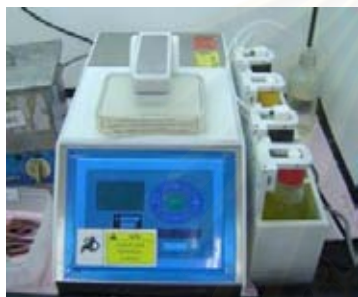
รูปที่ 4.8 เครื่อง Decapsulation และชิ้นงานที่ผ่านการ Decapsulation แล้ว
