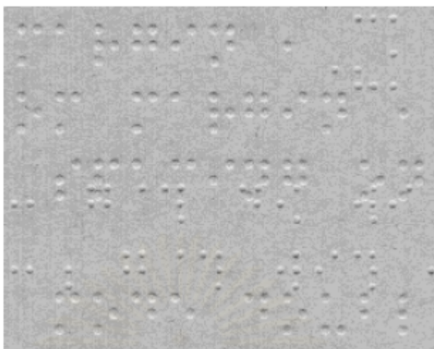
รูปที่ 2.4 ภาพที่ได้จากการสแกนเอกซเรย์ตัวอักษรเบรลล์ [3]
