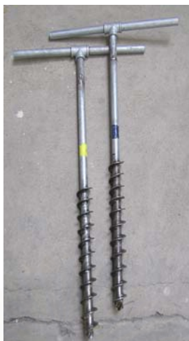
รูปที่ 3.6 อุปกรณ์ชุดเจาะบริเวณที่จะติดตั้งอุปกรณ์ตรวจวัดก๊าซเรดอน
