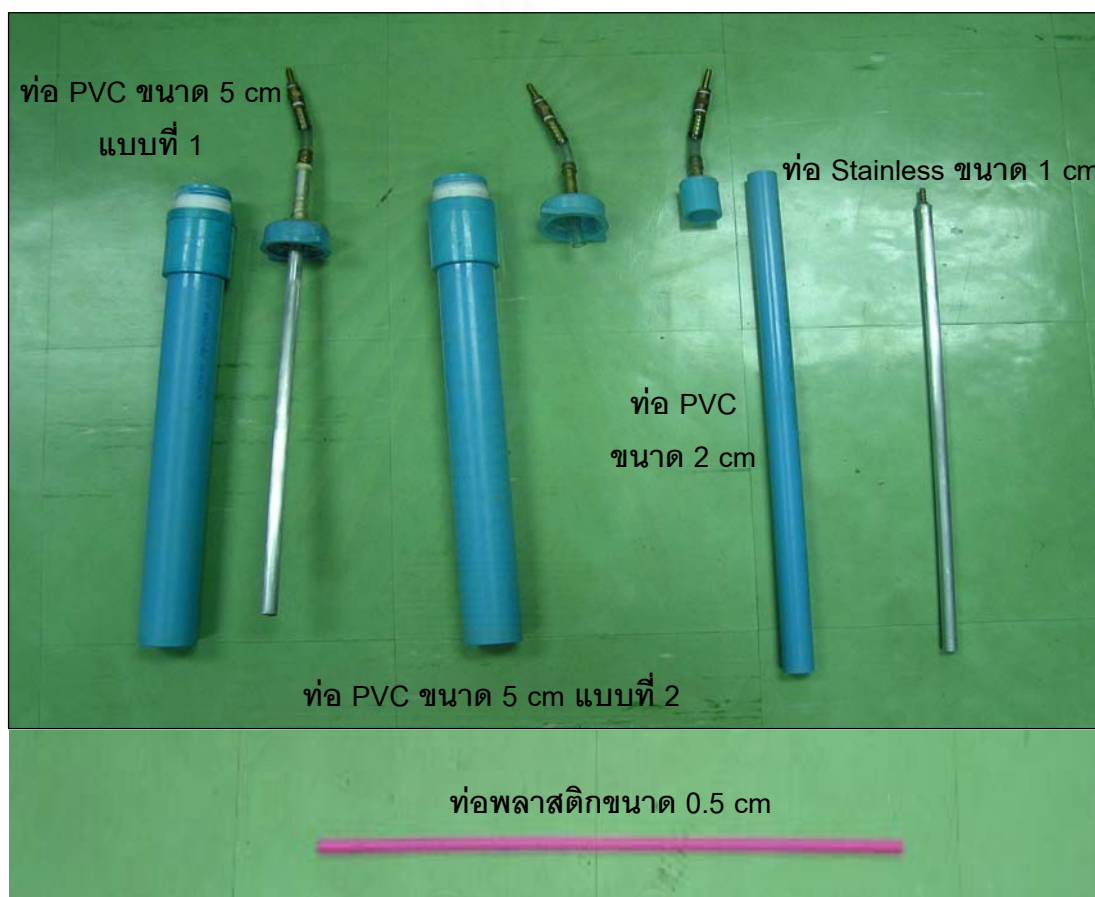
รูปที่ 3.2 ลักษณะ และขนาดต่างๆ ของท่อที่จะนำมาทำการทดสอบโปรบ
