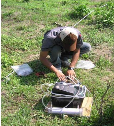
รูปที่ 3.8 การตรวจวัดโดยใช้เครื่องมือวัดก๊าซเรดอน โดยทำการติดตั้งโปรบในตำแหน่งต่างๆ ตามเส้นแนวสำรวจของพื้นที่
