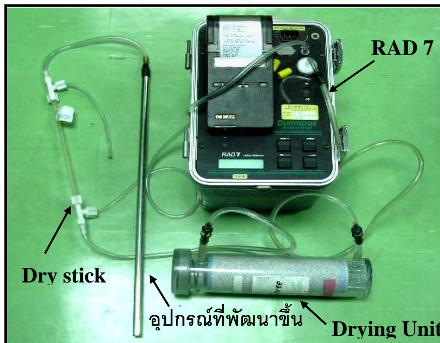
รูปที่ 4.3 การติดตั้งระบบ RAD IN SOIL โดยใช้อุปกรณ์ที่พัฒนาขึ้นประกอบร่วมกับ RAD 7
