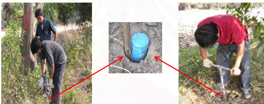
รูปที่ 3.10 การเตรียมหลุม เพื่อติดตั้งอุปกรณ์วัดก๊าซเรดอน (CR-39)
