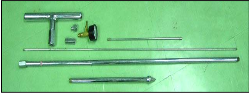
รูปที่ 2.15 อุปกรณ์ และส่วนประกอบต่างๆ ของ RAD IN SOIL
