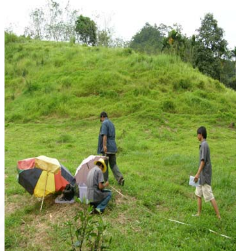
รูปที่ 3.8 การตรวจวัดโดยใช้เครื่องมือวัดก๊าซเรดอน โดยทำการติดตั้งโปรบในตำแหน่งต่างๆ ตามเส้นแนวสำรวจของพื้นที่
