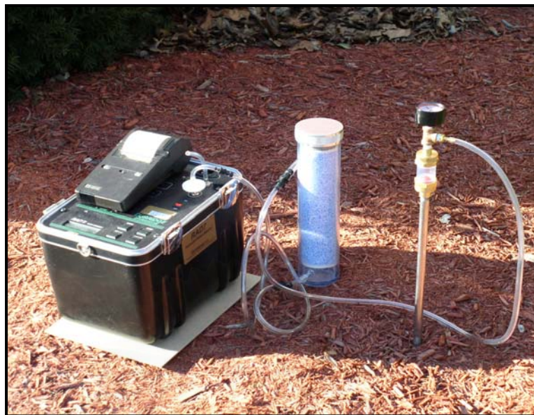
รูปที่ 2.17 การติดตั้งระบบตรวจวัดปริมาณก๊าซเรดอนแบบ RAD IN SOIL
