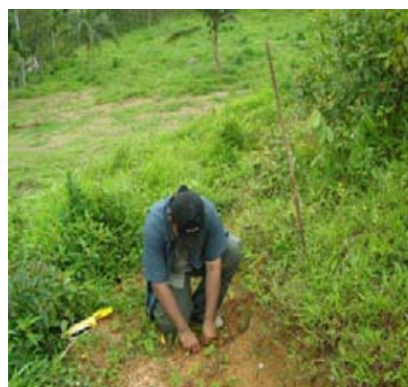
รูปที่ 3.7 การนำร่อง เพื่อทำการฝังโปรบที่ใช้ในการตรวจวัด
