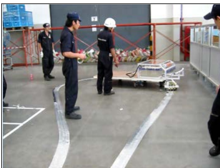
รูปที่ 5.13 ทำการทดลองรถ AGVs ตามเส้นทางที่กำหนด
