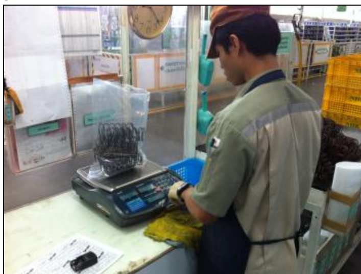
รูปที่ 5.17 พนักงานวางถุงลงที่เครื่องชั่งเพื่อทำการตั้งค่าเป็นศูนย์
