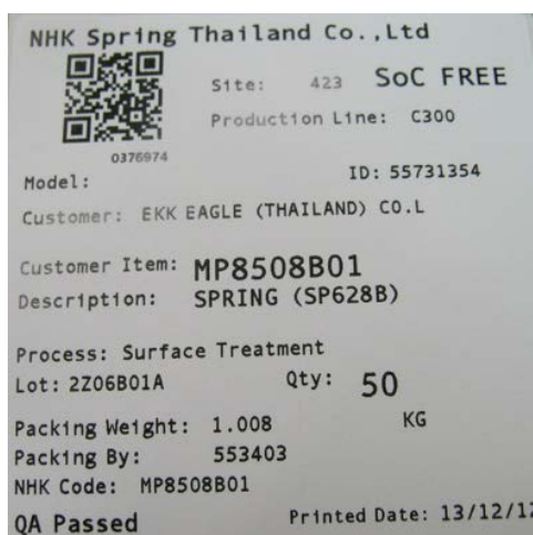
รูปที่ 5.23 ตัวอย่าง Tag card รูปแบบใหม่ซึ่งมีรหัสแท่งแบบสองมิติ
