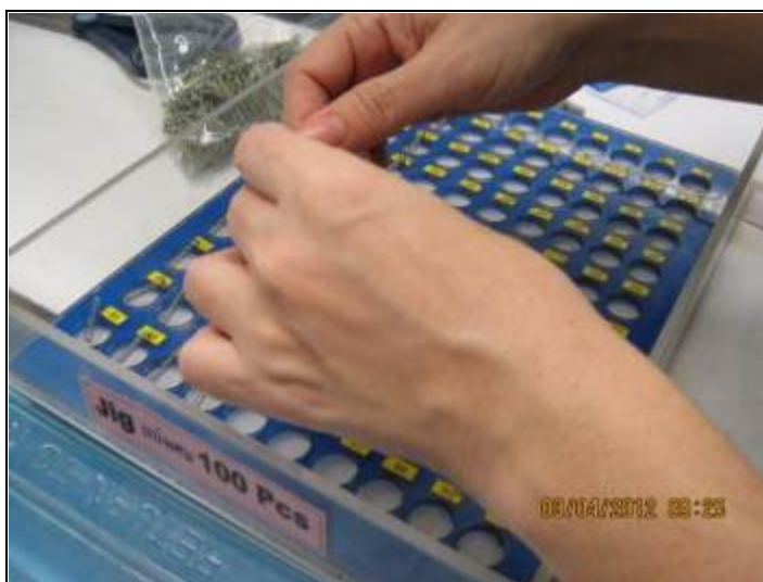
รูปที่ 5.19 อุปกรณ์ช่วยป้องกันความผิดพลาดจากการนับชิ้น
