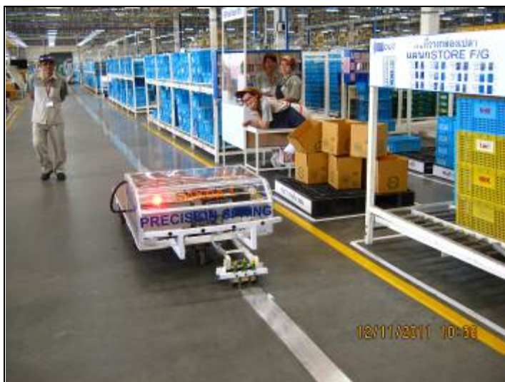
รูปที่ 5.14 ทำการทดลองรถ AGVs โดยการจอดตามจุดรับงาน
