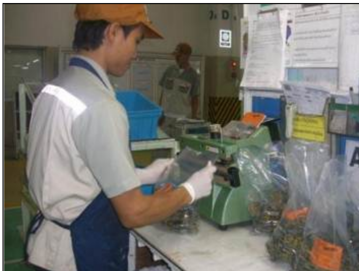
รูปที่ 3.2 ภาพประกอบขั้นตอนการบรรจุชิ้นงานใส่ถุง (Packing)
