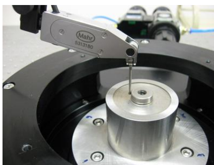
รูปที่ 5.13 วิธีการปรับความเยื้องศูนย์ของ Adaptor โดยใช้ Dial Test Indicator
