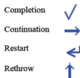
ภาพที่ 2.10 สัญลักษณ์กลไกเงื่อนไขของลิตเติล-จิล
