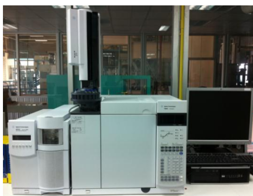
ภาพที่ 3.6 เครื่องแก๊สโครมาโทกราฟีประกอบด้วยแมสสเปกโตรมิเตอร์ (gas chromatography – mass spectrometer, GC-MS)
