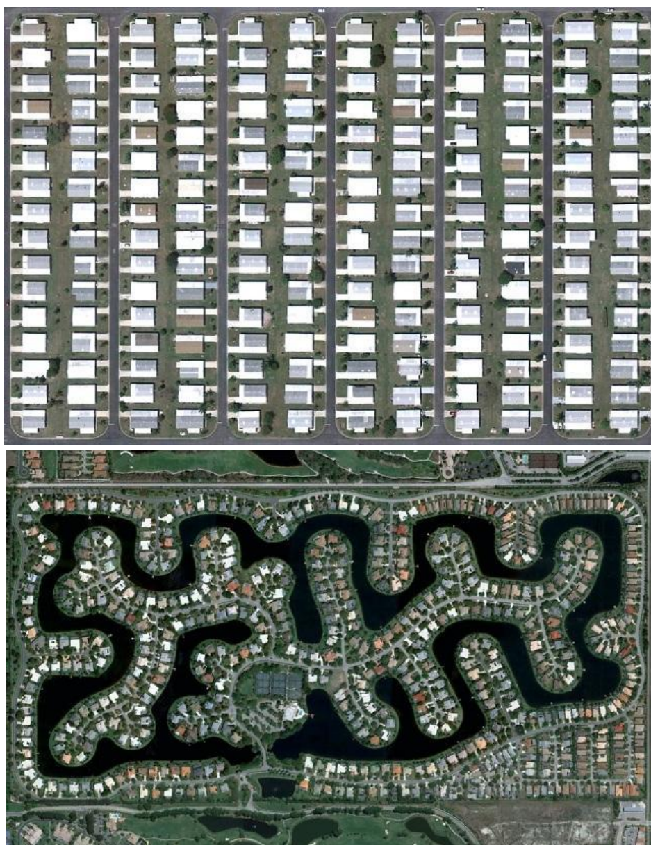
ภาพที่ 2-4 และ 2-5 โครงสร้างเส้นทางที่ซับซ้อนขึ้นทำให้เกิดทางตัดทางแยก (Intersections) หลากหลายรูปแบบ
