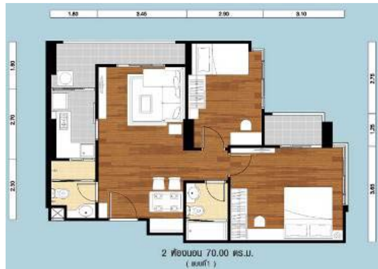
รูปที่ 4.22 แสดงแปลนห้องขนาด 2 ห้องนอน 70.00 ตร.ม. แบบที่ 1
