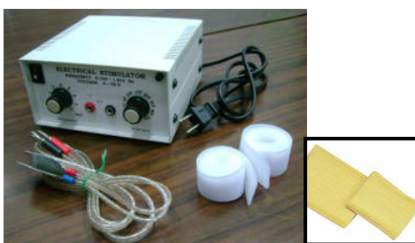
ภาพที่ 3.2 เครื่องกระตุ้นไฟฟ้าที่ผลิตโดยโรงพยาบาลจุฬาลงกรณ์
