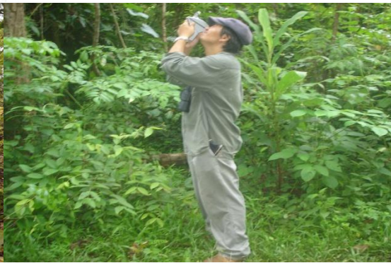
การวัดความสูงด้วยเครื่องมือ Haga hypsometer
