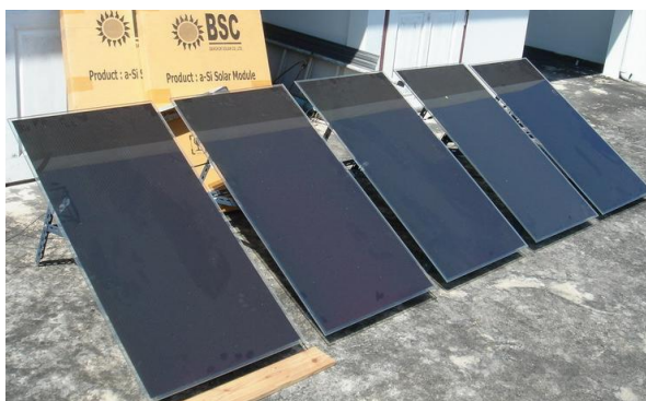
รูปที่ 8.9 แผงเซลล์แสงอาทิตย์ชนิด amorphous silicon ขนาด 50 วัตต์สำหรับใช้ทดลอง
