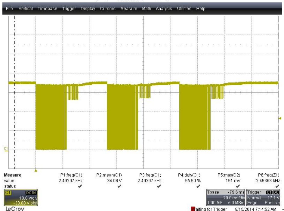
รูปที่ 7-6 รูปสัญญาณในการสื่อสารระหว่างมอดูลรวบรวมข้อมูลและมอดูลตรวจวัดที่ปรากฏในสายส่งไฟฟ้า
