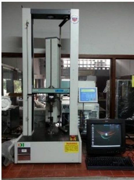
รูปที่ 5 เครื่องทดสอบสมบัติเชิงกล Universal testing machine
