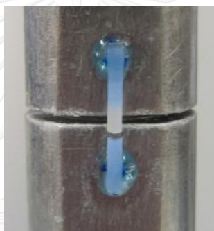
รูปที่ 29 ความล้มเหลวของชิ้นงานหลังจากให้แรงดึงด้วยเครื่องทดสอบสากล
