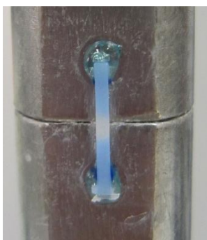
รูปที่ 28 การยึดชิ้นทดสอบกับแท่งโลหะที่ใช้สำหรับทดสอบความแข็งแรงดึงระดับจุลภาค
